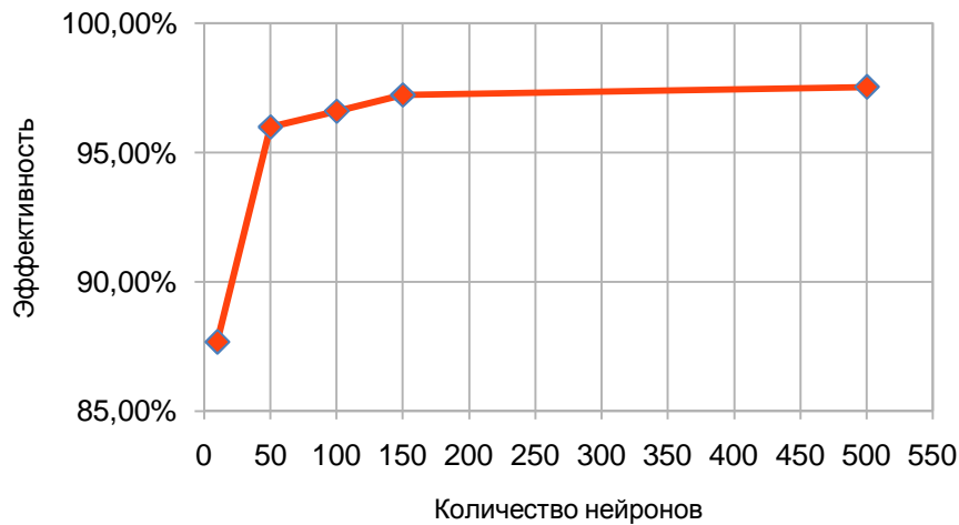
Рис. 2. Зависимость эффективности нейронной сети от количества нейронов скрытого слоя.
