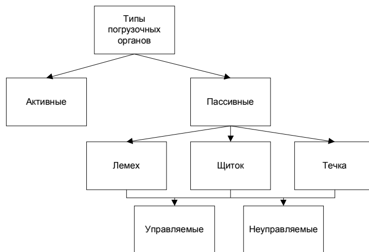
Рис. 7 – Классификационная схема угледобывающих комбайнов по типам погрузочных органов
