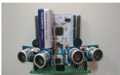
Рисунок 3 – Макет сенсора с двумя ультразвуковыми датчиками
