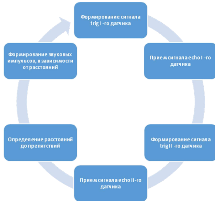
Рисунок 1 – Алгоритм работы микроконтроллера с двумя сенсорами
