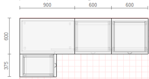
Рис. 8. Габарити робочої поверхні після корекції
