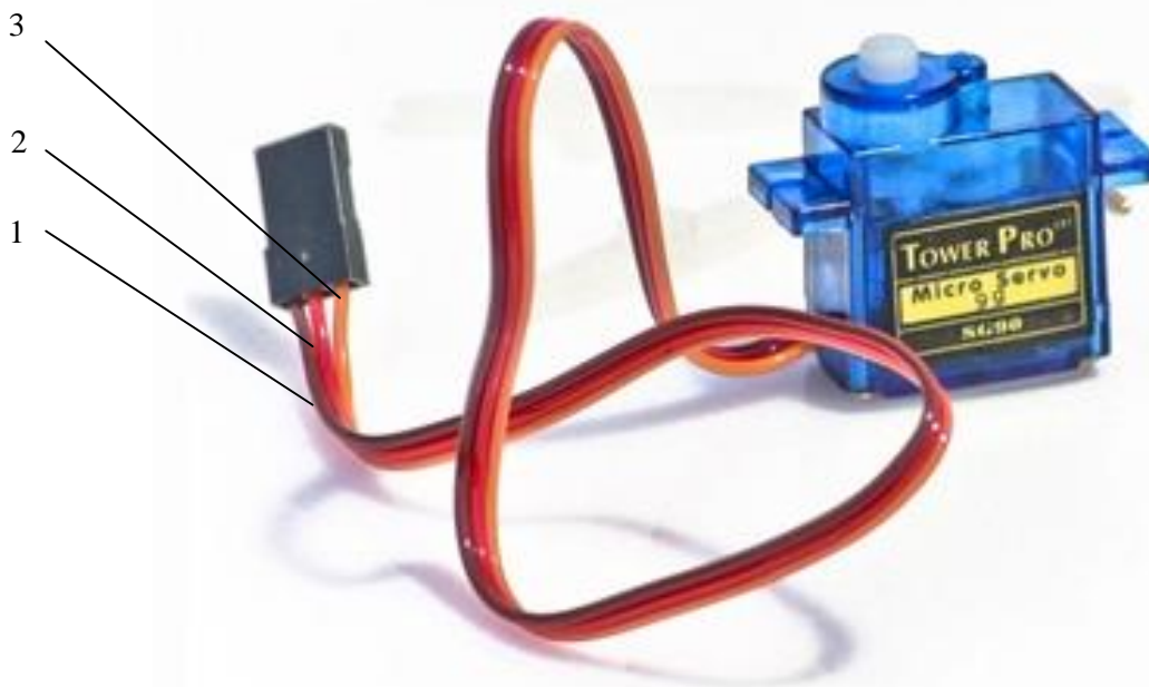
Рис. 3. Сервопривід Tower Pro 9g SG90: 1 – коричневий провід — земля (Ground, підключається до піну GND на платі Arduino); 2 – червоний провід — живлення +5В (підключається до піну 5В на платі Arduino); 3 – жовтий провід — сигнал керування (підключаємо до цифрового піну Arduino)[8].
