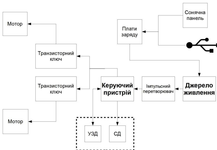
Рис. 1. Структурна схема робототехнічної системи
