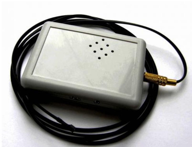
Рис. 1. Балакучий термометр "Градус — 05"
