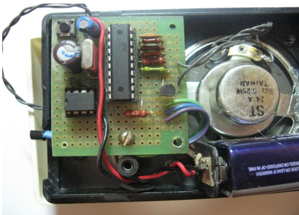
Рис. 2. Загальний вигляд електронного термометра з голосовим управлінням
