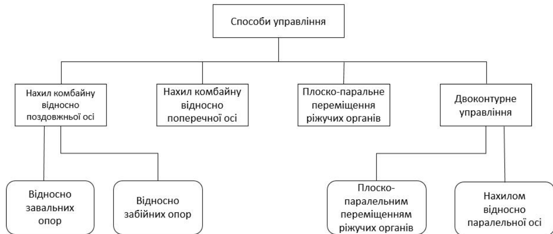
Рис. 1.1. Класифікаційна схема способів управління комбайнами в профілі пласта
