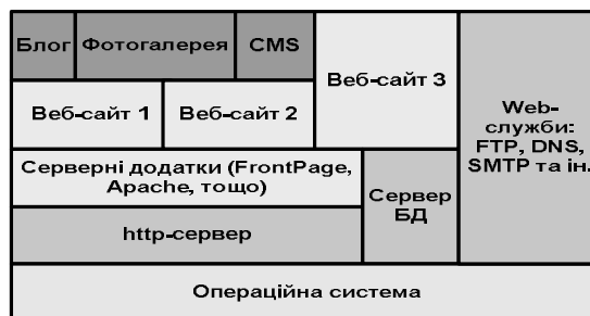
Рис.1. Структура програмного забезпечення веб-сервера
