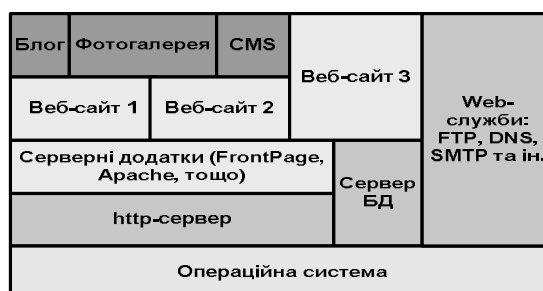
Рис.1. Структура програмного забезпечення веб-сервера
