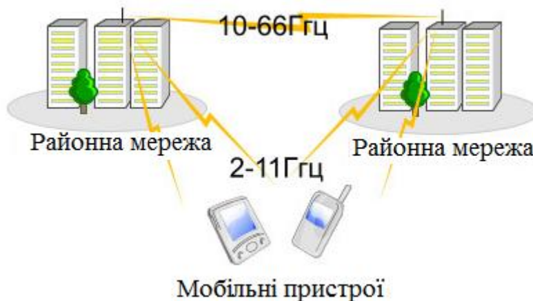
Рис. 2 – Базове представлення мобільного WiMax.
