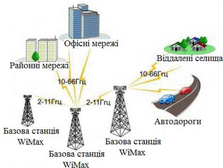
Рис.1 – Базове представлення мережі WiMax.
