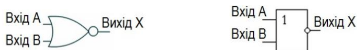
Рис.4. Графічне позначення логічного елемента АБО-НЕ, що консолідує в собі схему зображену на рис.3с.
