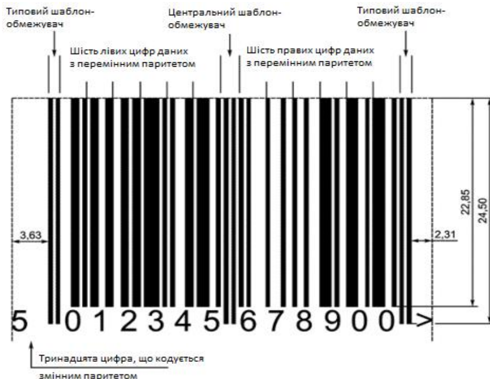
Рисунок 1 — Символ штрихового коду EAN-13
