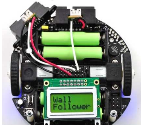
Рис. 6. Розміщення давачів відстані на мобільному агенту Pololu 3pi
