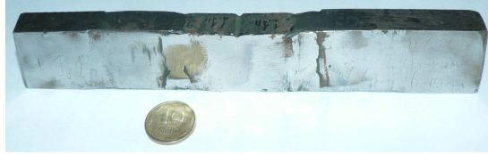
Рис. 2. Загальний вигляд призматичного зразка для дослідження закономірностей розвитку краєвих тріщин.
