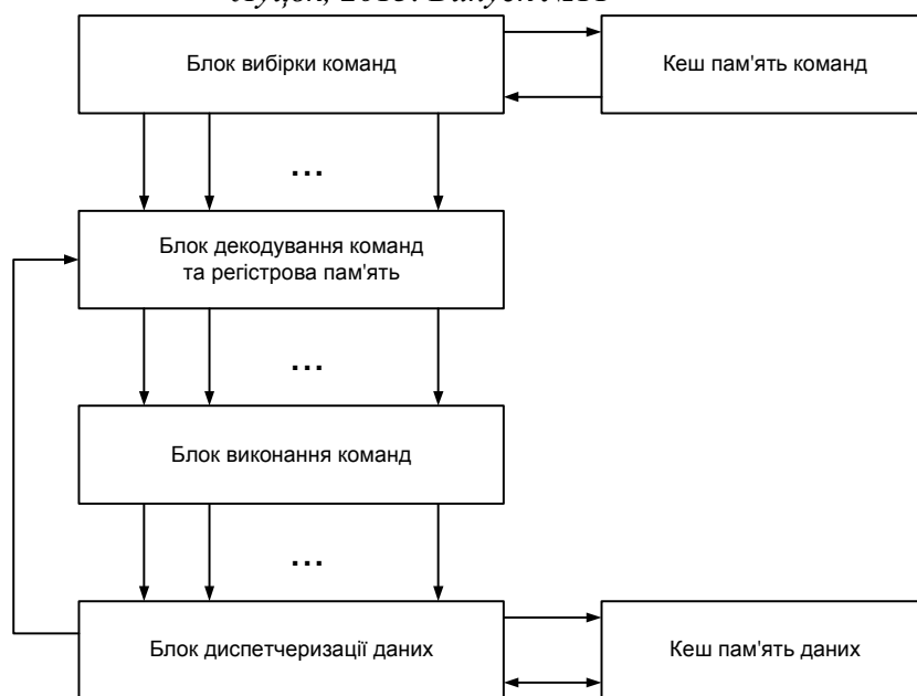
Рис.1. Структура суперскалярного процесора Авторська розробка
