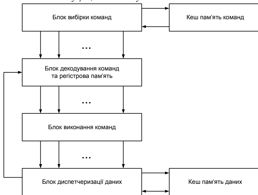
Рис.1. Структура суперскалярного процесора Авторська розробка
