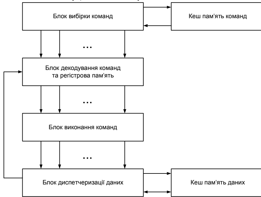
Рис.1. Структура суперскалярного процесора Авторська розробка
