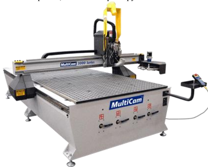
Рис. 1. Загальний вигляд фрезерно-гравірувального верстата MultiCam 3000 Series
