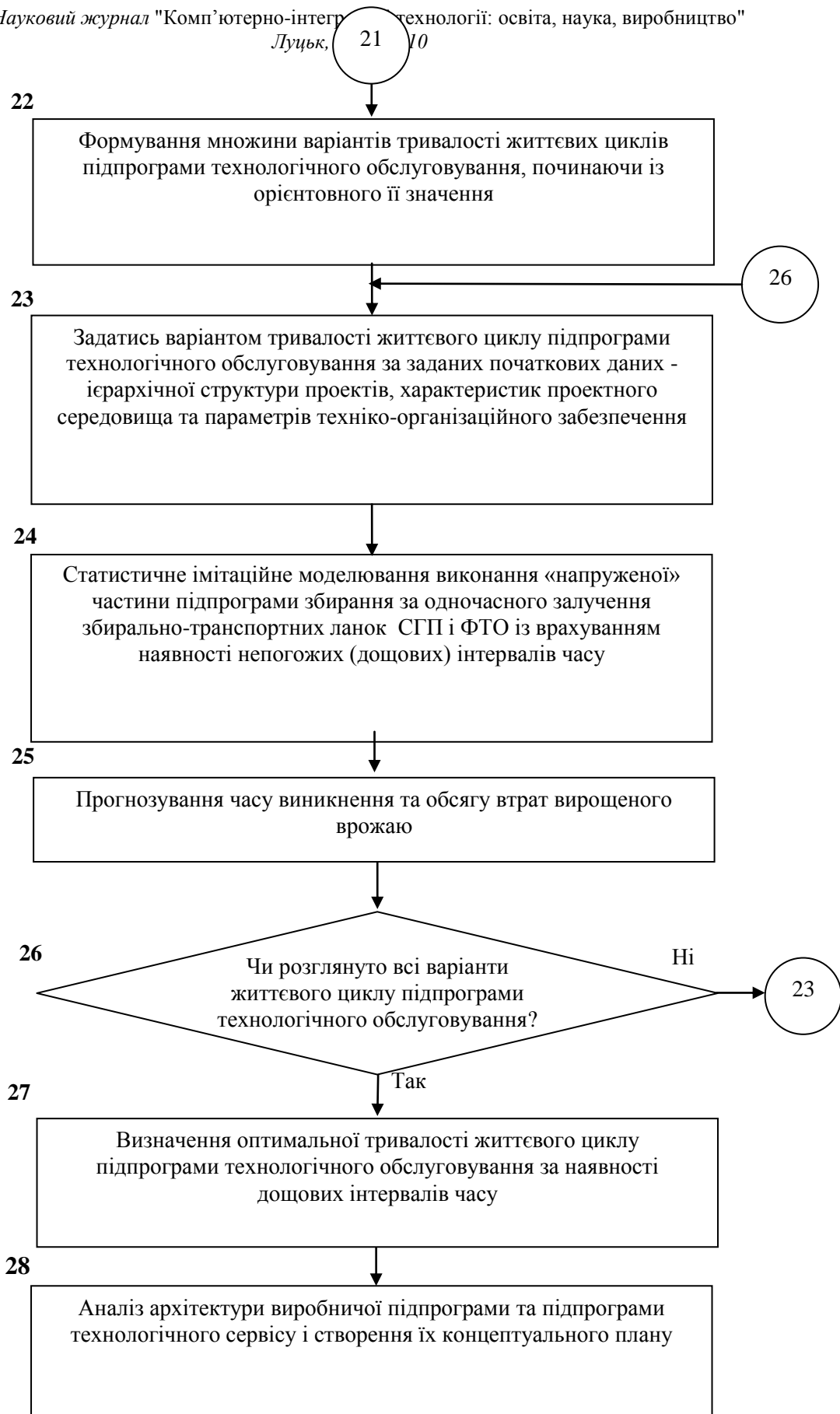
Рис. Схема алгоритму управління архітектурою проектів підпрограм технологічного обслуговування виробничих підпрограм збирання ранніх зернових культур (закінчення)
