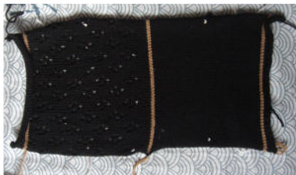
Рис. 3. Розділення зразків за допомогою контрастної нитки
