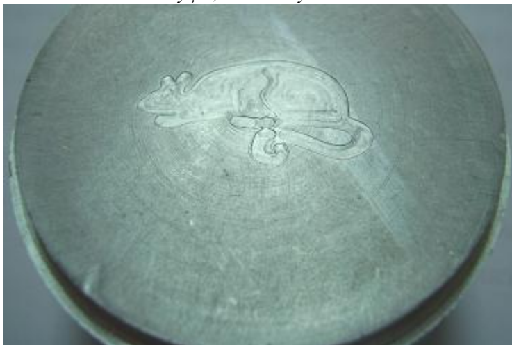
Рис. 4. Виготовлена деталь з складною траєкторією у вигляді «пацюка».
