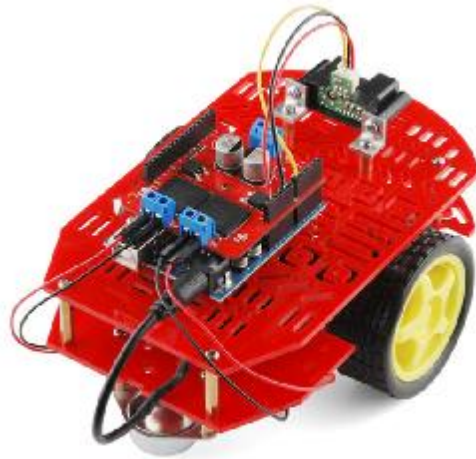
Рис. 1. Рухома двоколісна платформа Magician Chassis
