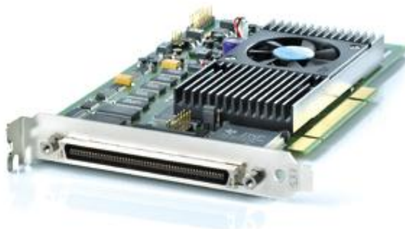
Рис. 2. Контролер ds1104 фірми dSpace.
