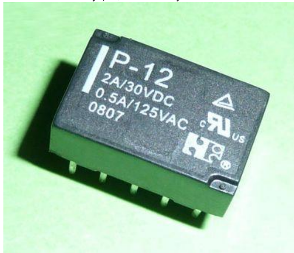
Рис. 4. Зовнішній вигляд реле марки P-12.
