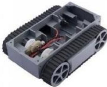
Рис. 1. Мобільна платформа RP5 на гусеничному ході
