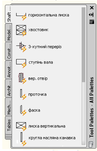
Рис. 2. Вкладка «Shaft Library» зі створеними динамічними блоками
