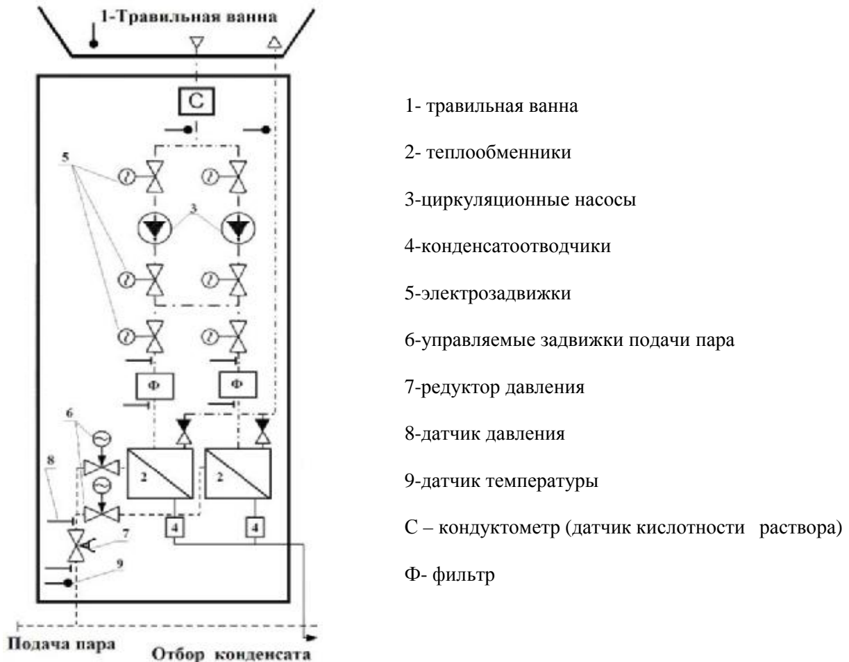
Рис.3. Принципиальная схема модуля нагрева травильного раствора
