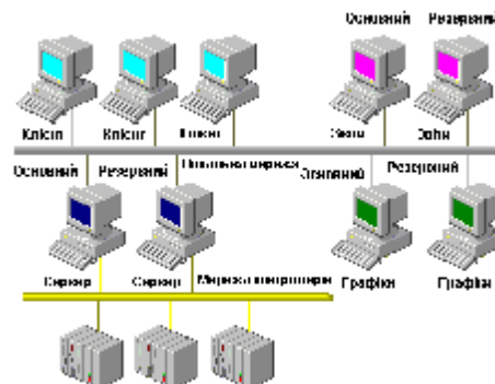
Рис. 5. Резервування задач відображення графіків і виводу звітів
