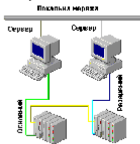
Рис. 8. Резервування обміну даними за допомогою локальної мережі
