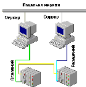
Рис. 8. Резервування обміну даними за допомогою локальної мережі
