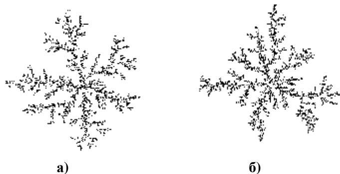
Рис. 4. Структура кластера мережі (для різних значень коефіцієнта дифузії: а – D=1 , б – D=0,5 ).
