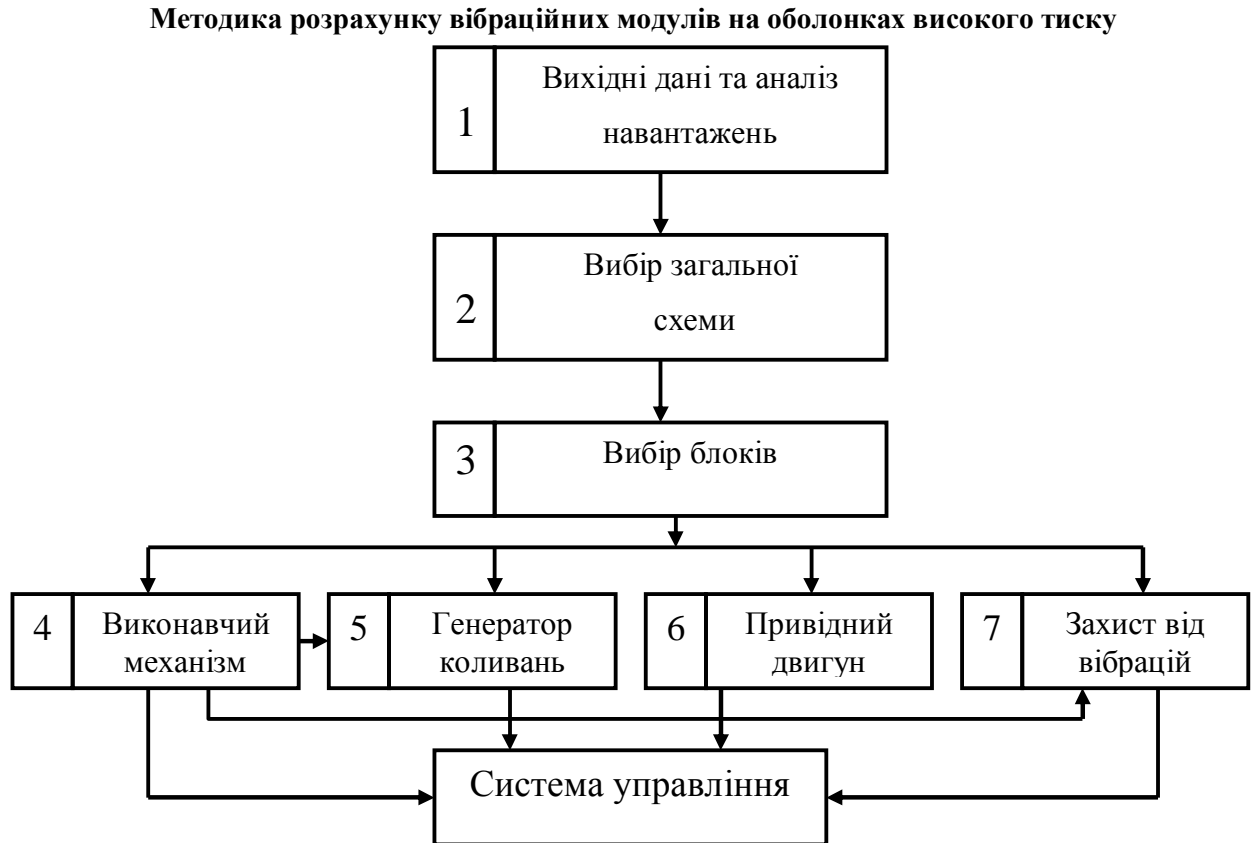
Рис. 5. Загальна блок – схема проектування та розрахунку вібраторів на оболонках високого тиску
