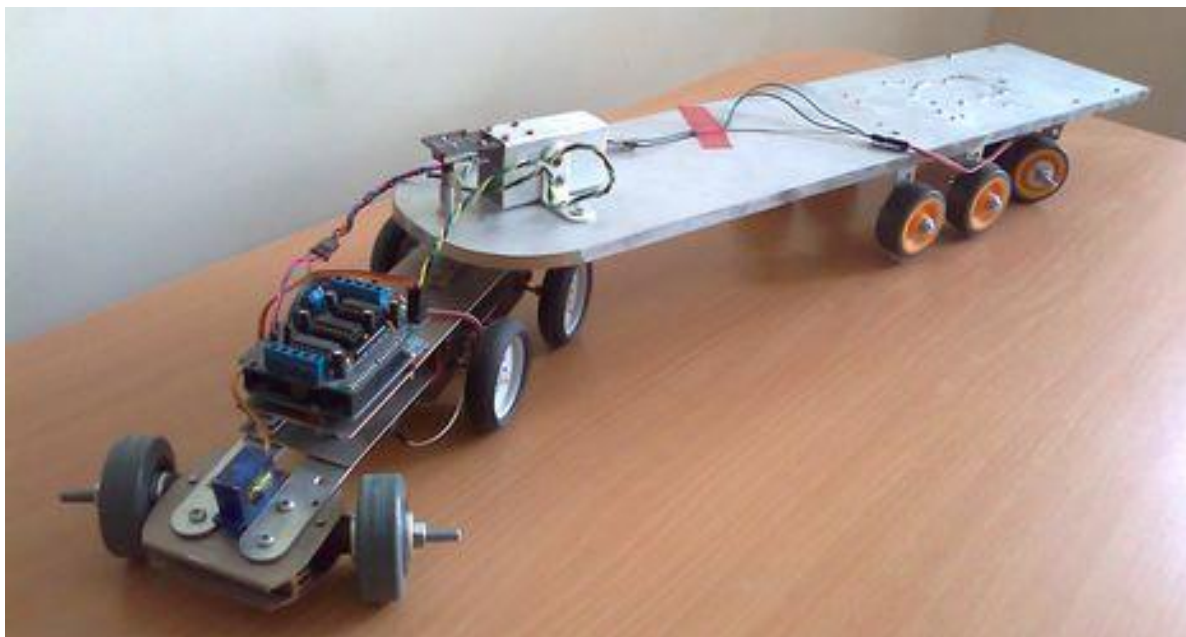
Рисунок 1. Модель автопоїзда з керованою причіпною ланкою.
