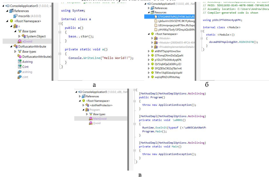
Рис. 6. С#-код програми HelloWorld, одержаний з захищеної збірки за допомогою декомпілятораJetBrains dotPeek
