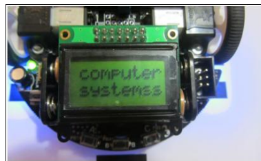
Рис. 5. Відображення символів на дисплеї робота
